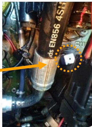
A **caixa 4 furos** é uma caixa distribuidora de potência que direciona a potência do motor para as bombas que irão realizar todas as funções de movimentação do equipamento.
