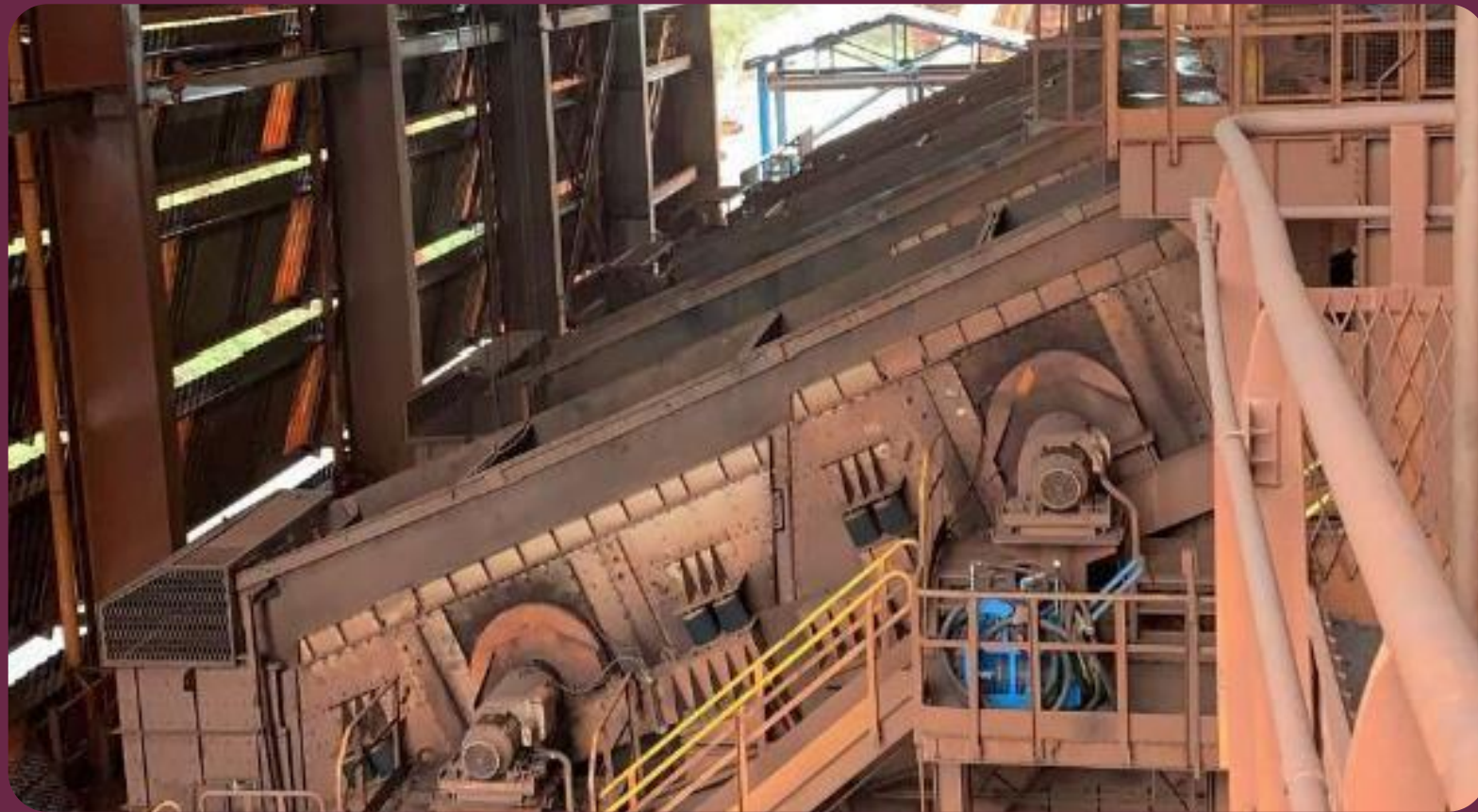
Peneira monitorada com os sensores Dynamox
