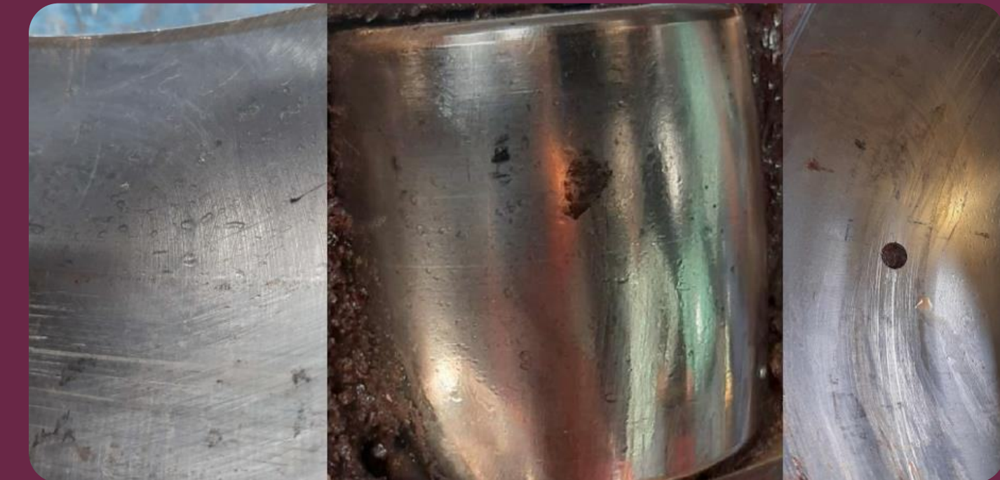
Marcas nas pistas interna, externa e elemento rolante
