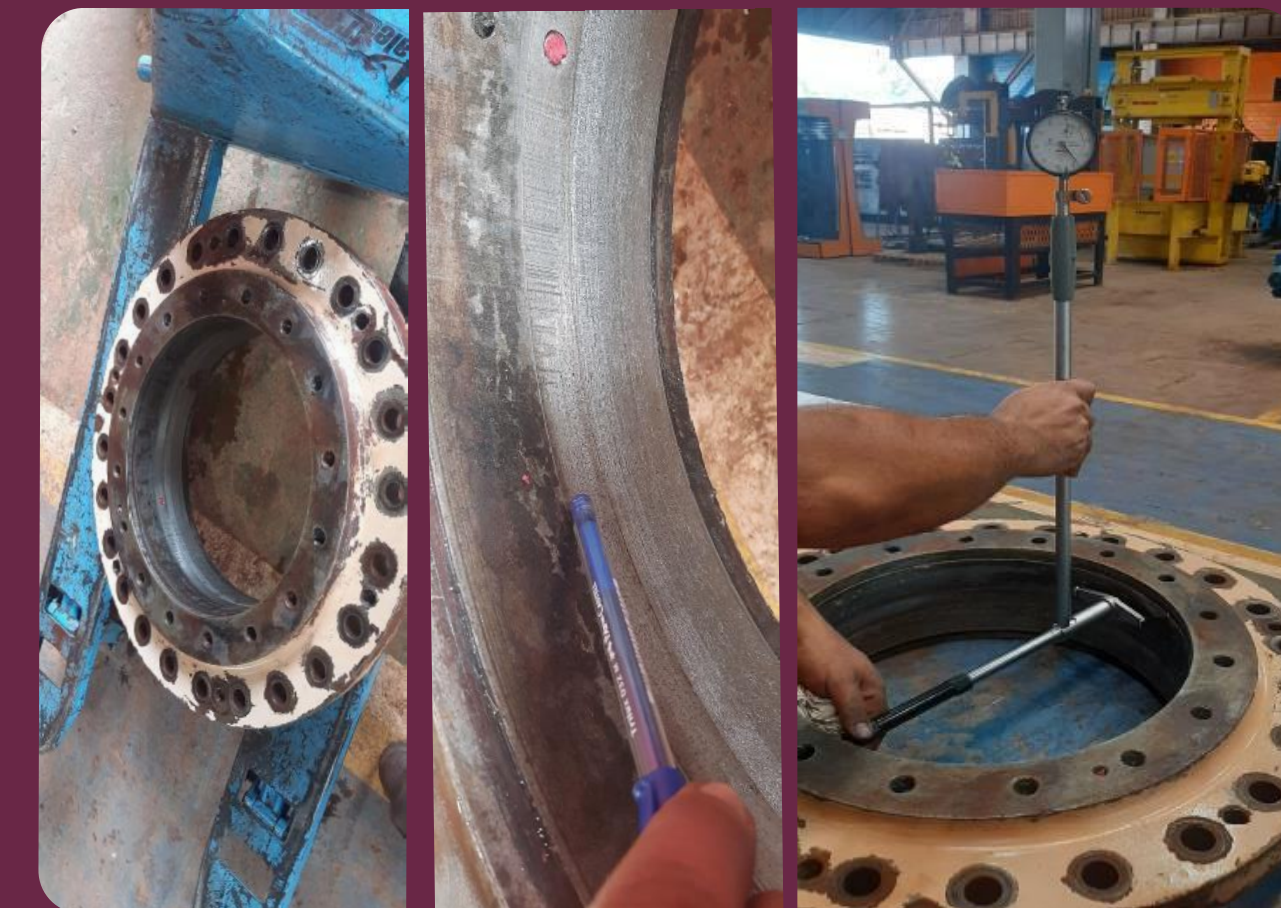
Área interna de desgaste do mancal da bolsa de rolamento
