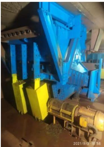
Revitalização do chute de alimentação e instalados novos cavaletes com reforço estrutural, para suportar melhor as cargas aplicadas. Com os novos cavaletes, há também a melhoria ergonômica por serem do tipo gaveta, assim os empregados podem desmontar parcialmente, e os rolos são substituídos sem o peso da correia, oferecendo maior segurança na atividade.
