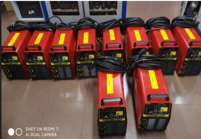
A Ferramentaria Central do Pátio disponibilizou 1 máquina de solda portátil, 440V com dispositivo VRD nova, para uso e responsabilidade de cada turma de execução da Gerência de Manutenção Estocagem e Expedição.
