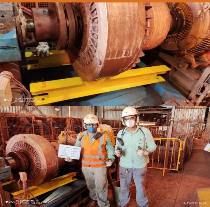
Melhoria realizada pela equipe preventiva A - Suporte de apoio do acoplamento hidrodinâmico TR-3011-24 M2.
