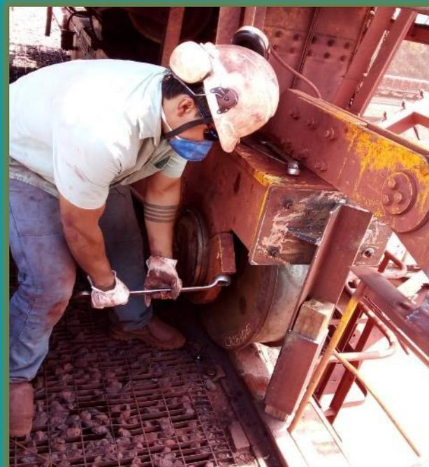
Montagem e aperto dos parafusos da proteção lateral e da base do mancal da roda 6, RC-3011-01.
