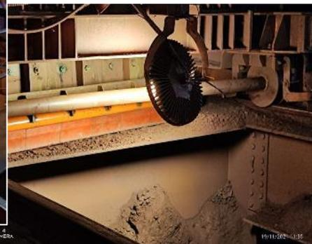
Instalado limpador transversal no TR-3030-01, para remover o material que se acumula na aba do silo. Com objetivo de reduzir o número de paradas corretivas e liminar a falha por patinação do tripper.
